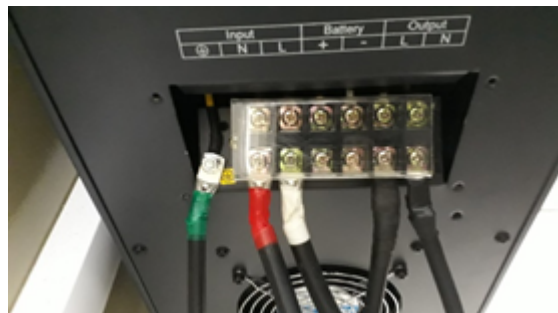
Figura 1: Necessidade de conexão na entrada e saída do tipo borne.
