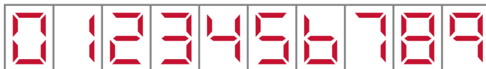
Figura 4.3 - Formato dos dígitos no display de 7 segmentos
