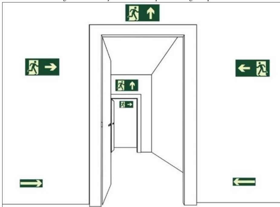
Figura 36. Sinalização de saída sobre paredes e vergas de portas
