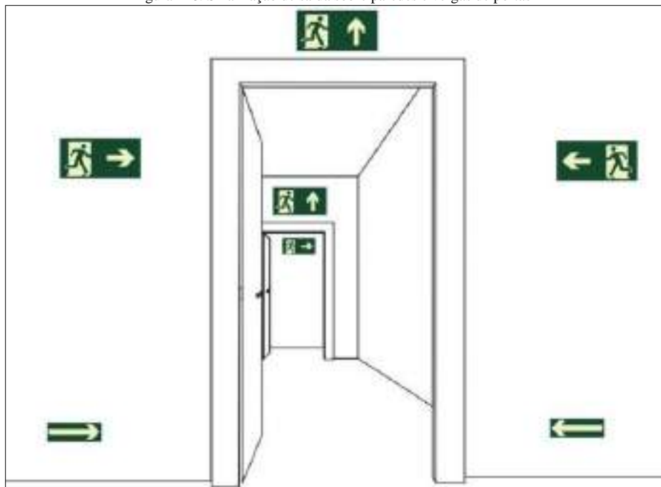
Figura 128. Sinalização de saída sobre paredes e vergas de portas
