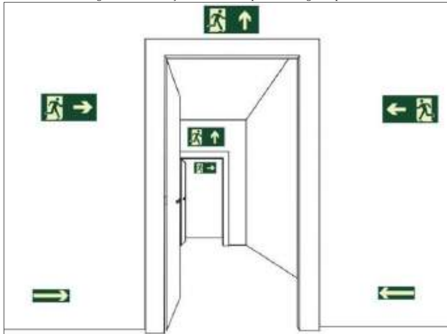
Figura 213. Sinalização de saída sobre paredes e vergas de portas
