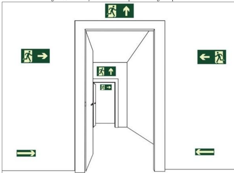
Figura 78. Sinalização de saída sobre paredes e vergas de portas
