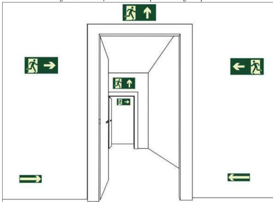
Figura 54. Sinalização de saída sobre paredes e vergas de portas
