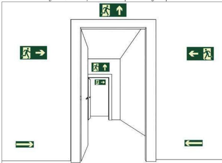
Figura 140. Sinalização de saída sobre paredes e vergas de portas
