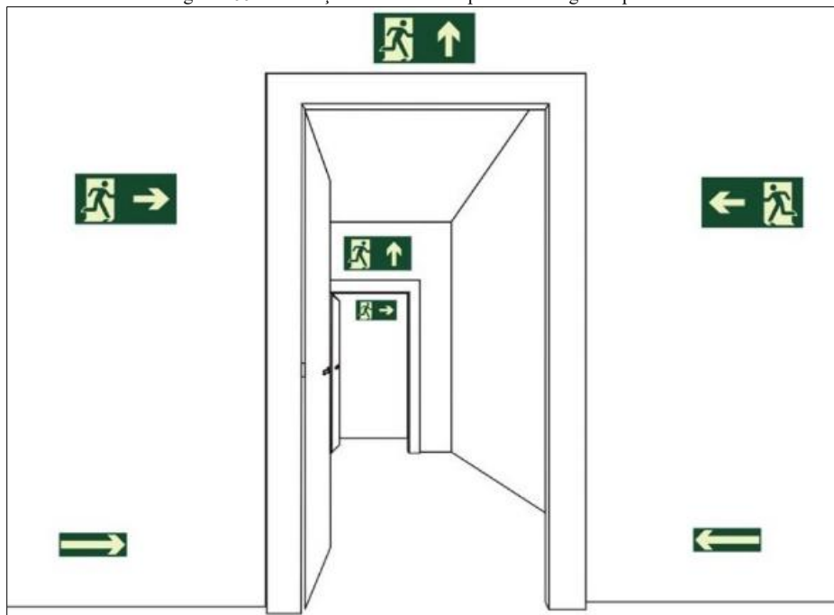
Figura 166. Sinalização de saída sobre paredes e vergas de portas
