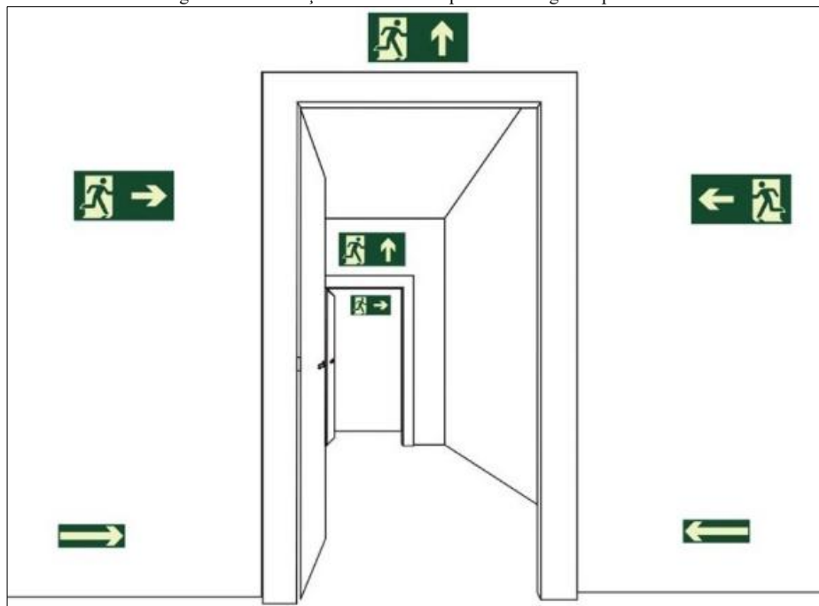
Figura 42. Sinalização de saída sobre paredes e vergas de portas
