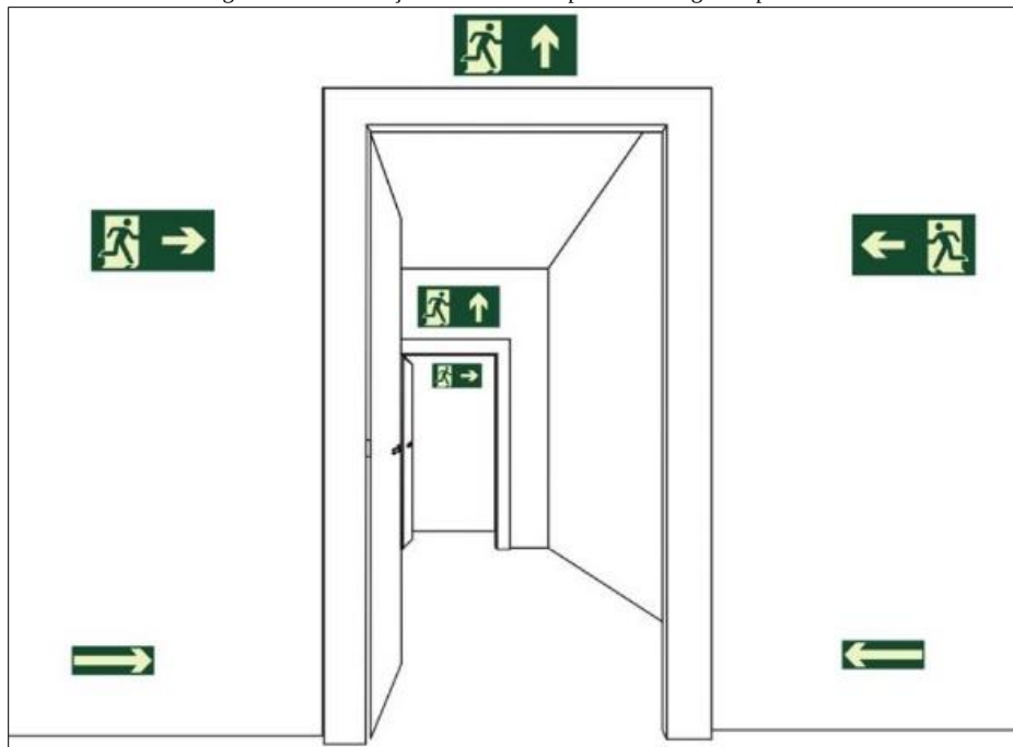
Figura 161. Sinalização de saída sobre paredes e vergas de portas
