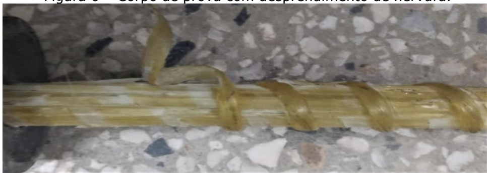
Figura 6 – Corpo de prova com desprendimento de nervura.
