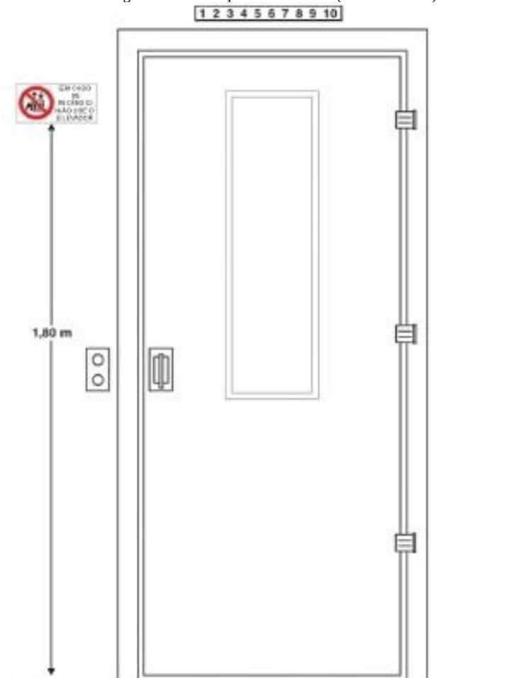
Figura 27. Sinalização de elevadores (vista da escada)
