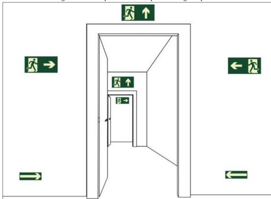
Figura 18. Sinalização de saída sobre paredes e vergas de portas
