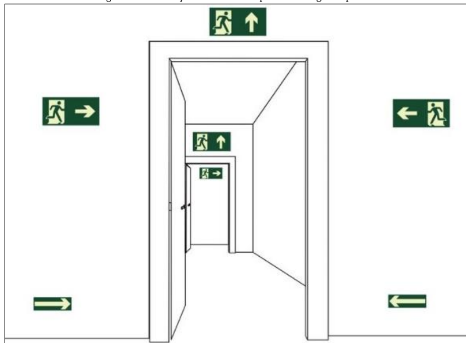
Figura 17. Sinalização de saída sobre paredes e vergas de portas
