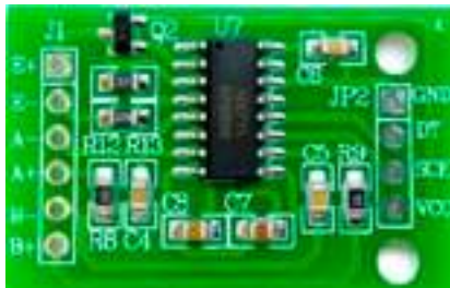
Figura 3 - Módulo HX711. Fonte: https://www.usinainfo.com.br/amplificadores-de-sinal/modulo-conversor-amplificador-hx711-24bit-2-canais2818.html?search_query=hx711&results=6
