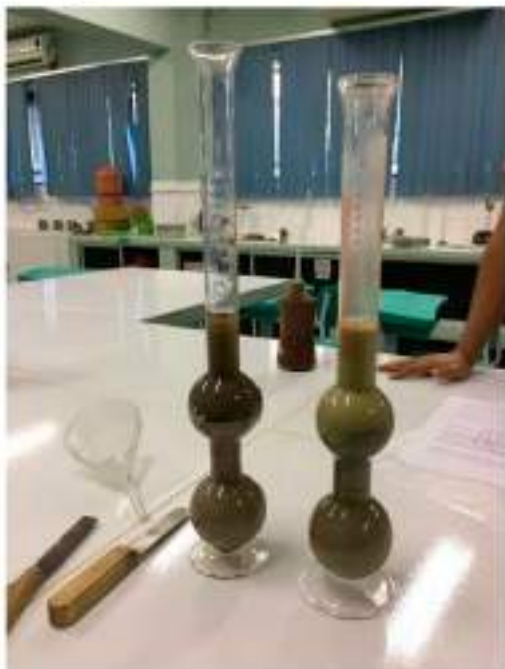
Figura 1. Ensaio com o Frasco de Chapman.
