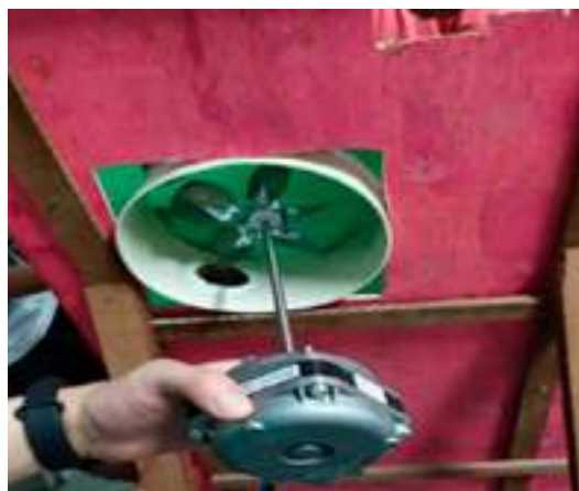
Figura 05 – Cápsula das pás do rotor da microturbina
