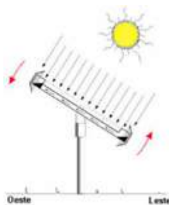
Figura 1 – Seguidor Solar Passivo. Fonte: (OLIVEIRA, 2007).
