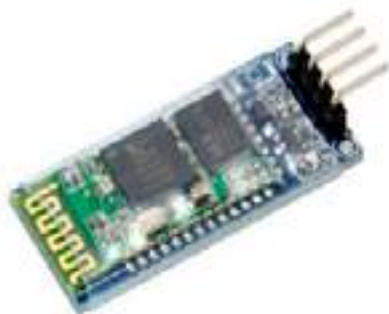
Figura 4 - Módulo Bluetooth HC-06. Fonte: https://www.usinainfo.com.br/bluetooth-arduino/modulo-bluetooth-hc-06-arduino-slave2826.html?search_query=bluetooth+HC-06+&results=6
