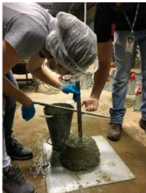
Figura 3. Ensaio de Slump Test.
