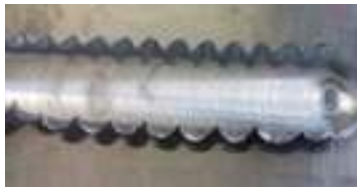
Figura 4. Formação excessiva de rebarbas. Fonte: Autora (2020).
