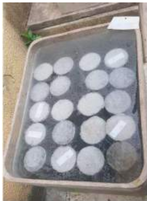
Figura 4. Cura dos corpos de prova.
