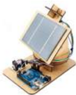
Figura 5 – Rastreador Solar com Arduino e Sensor LDR.
