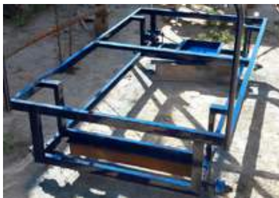
Figura 1 – Montagem da para estrutural do trem.
