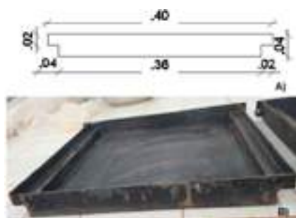
Figura 3 - Protótipo 1: A) desenho; B) confeccionado 40cmx40cm Fonte: Autor, 2019.
