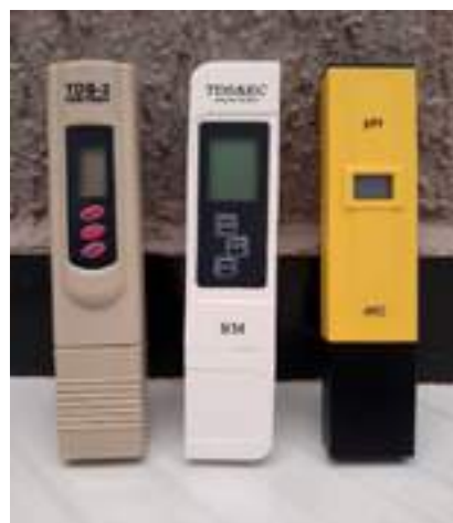
Figura 2: medidores digitais (TDS, TDS/EC e pH).
